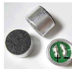
随着音波的流入使金属振动板振动时，振动板与电极板会随音波的振动，产生距离上的变化，这种物理变化的现象，解释为静电容量的变化。因驻极式话筒的静电容量值很小，电器的耗电流量较大，所以不可直接使用于一般的放大器上。为符合放大器所要求的输入信号耗电流，必须要经由 JFET 使电流量转换成放大器可接受的程度，因此现在大部分驻极式话筒内部还有一片电流放大集成电路 (FET)，要注意接线时驻极式话筒的极性。
