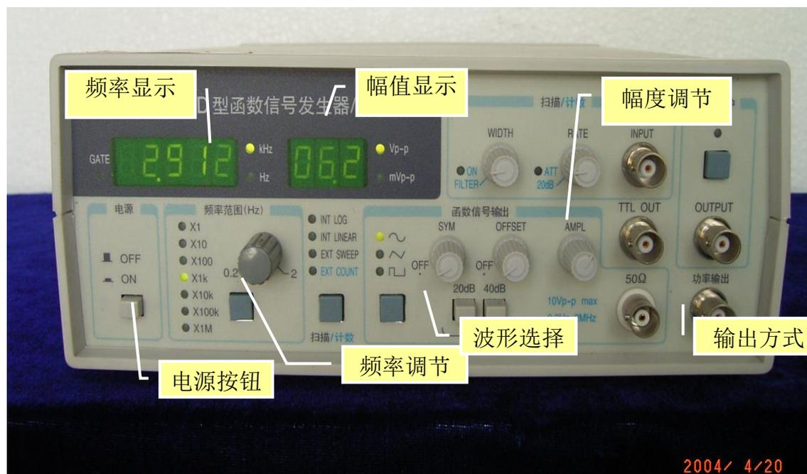
EE1641B 型函数信号发生器/计数器面板功能如图。
